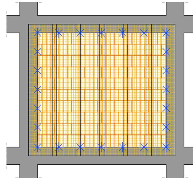
**CASO 1:** Sezione intervento di collegamento perimetrale a pilastri e travi EMERGENTI mediante sistema FRCM.
