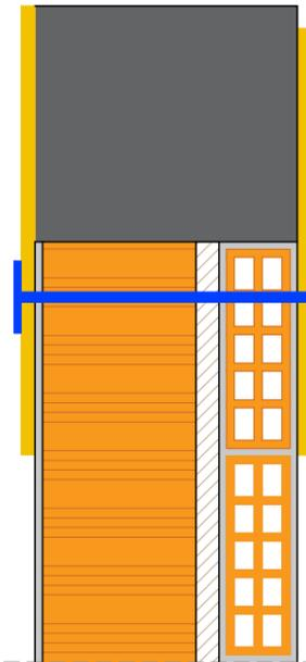
**CASO 2:** Sezione intervento di collegamento perimetrale a pilastri e travi a SPESSORE mediante sistema FRCM.
