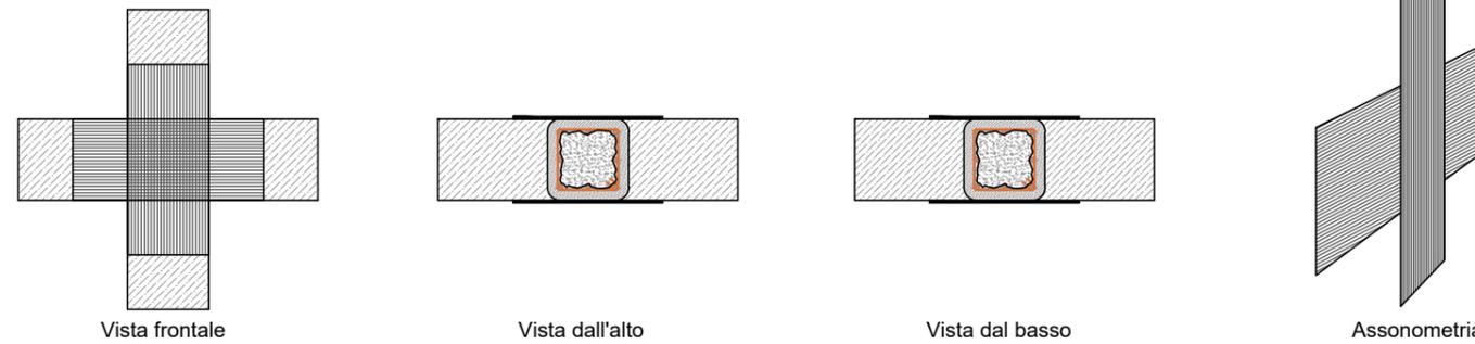
INCREMENTO DI DUTTILITÀ DEL CALCESTRUZZO E DELLA RESISTENZA A TAGLIO DEI PILASTRI
