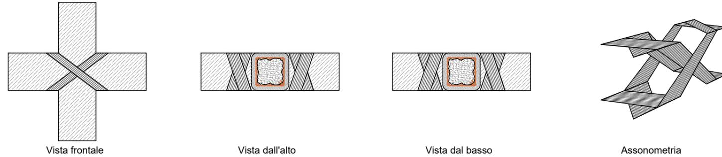
INCREMENTO DELLA RESISTENZA A TAGLIO DEL PANNELLO DI NODO
