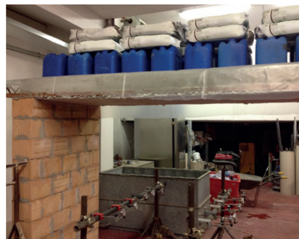
Prova di carico sistema X Plaster sino a 300 \text{ kg/m}^2 .
