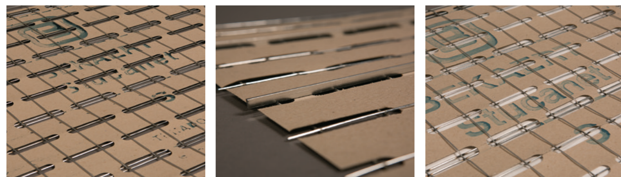
Stucanet S - Rete con "doppio filo" di sostegno per fissaggio fino a 45 cm. Stucanet 80 - Rete con "nervatura" di sostegno per fissaggio fino a 60/80 cm. Stucanet BM - Rete con "Doppio filo" di sostegno e membrana traspirante.
