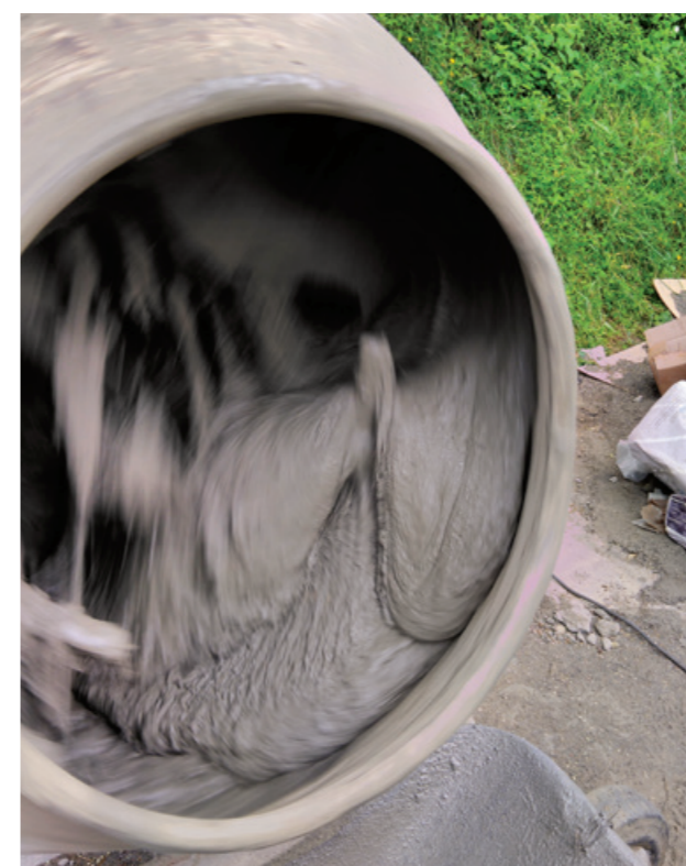
Miscelazione nella tradizionale betoniera a bicchiere di Micro Gold Steel .
