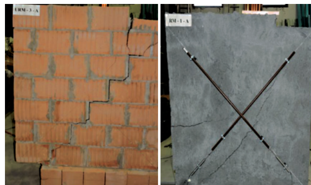
Modalità di rottura dei test a compressione diagonale di pannelli murari (a sx pannello non rinforzato, a dx pannello rinforzato con MX-PVA Fibrorinforzata) | Report Università degli studi di Perugia.
