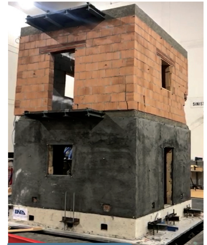
Struttura rinforzata mediante MX-PVA.
