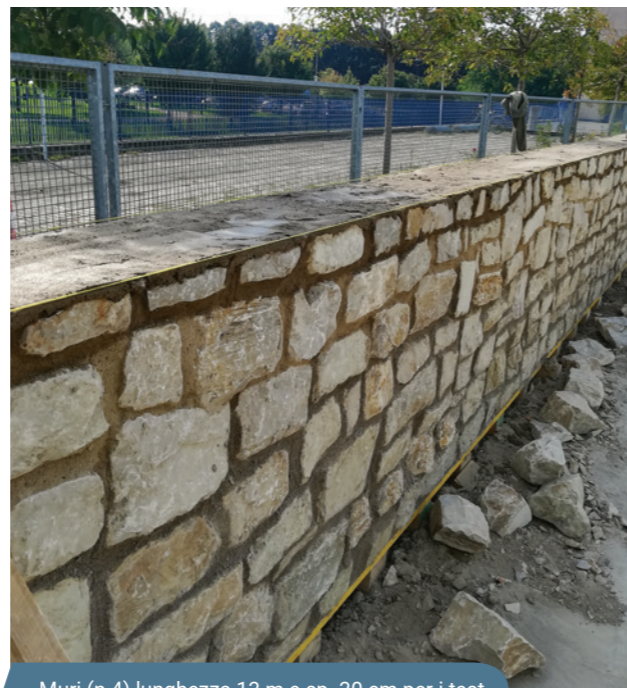
Muri (n.4) lunghezza 13 m e sp. 30 cm per i test.
