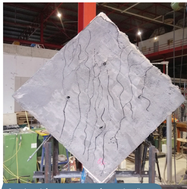
Campione rinforzato post prova: fessurazione lieve.
