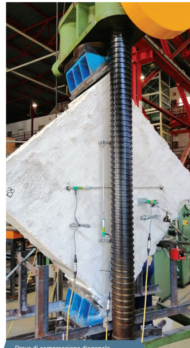
Prova di compressione diagonale.
