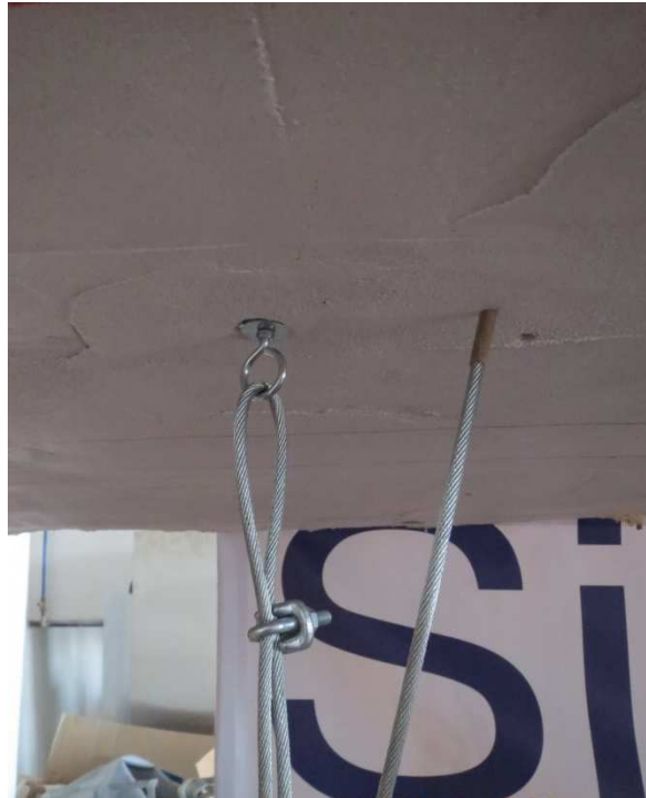
Foto n. 5 – Modalità di applicazione della forza di estrazione al tassello nella prova “pilota”
