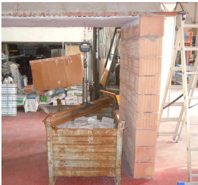
Foto n. 2.1 – Apparecchiatura per l'applicazione e la misura della forza
