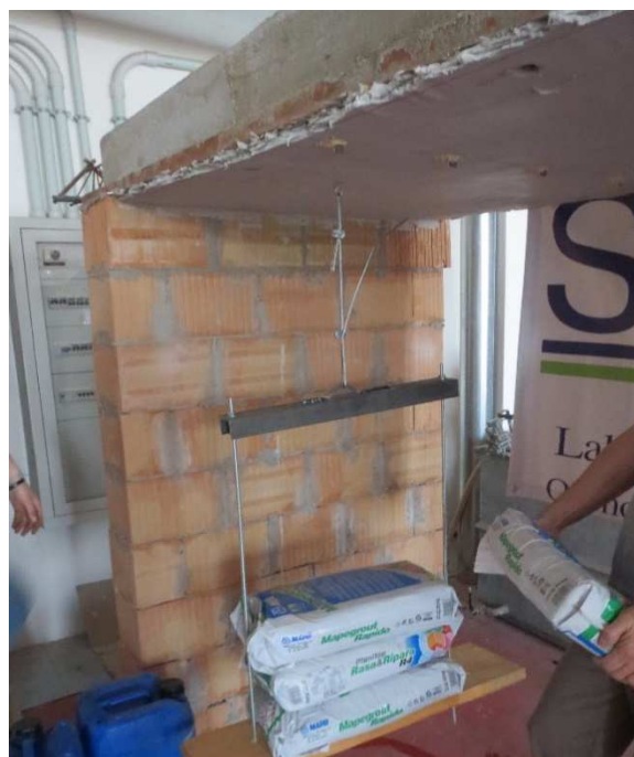
Foto n. 6 – Applicazione del carico nella prova “pilota”
