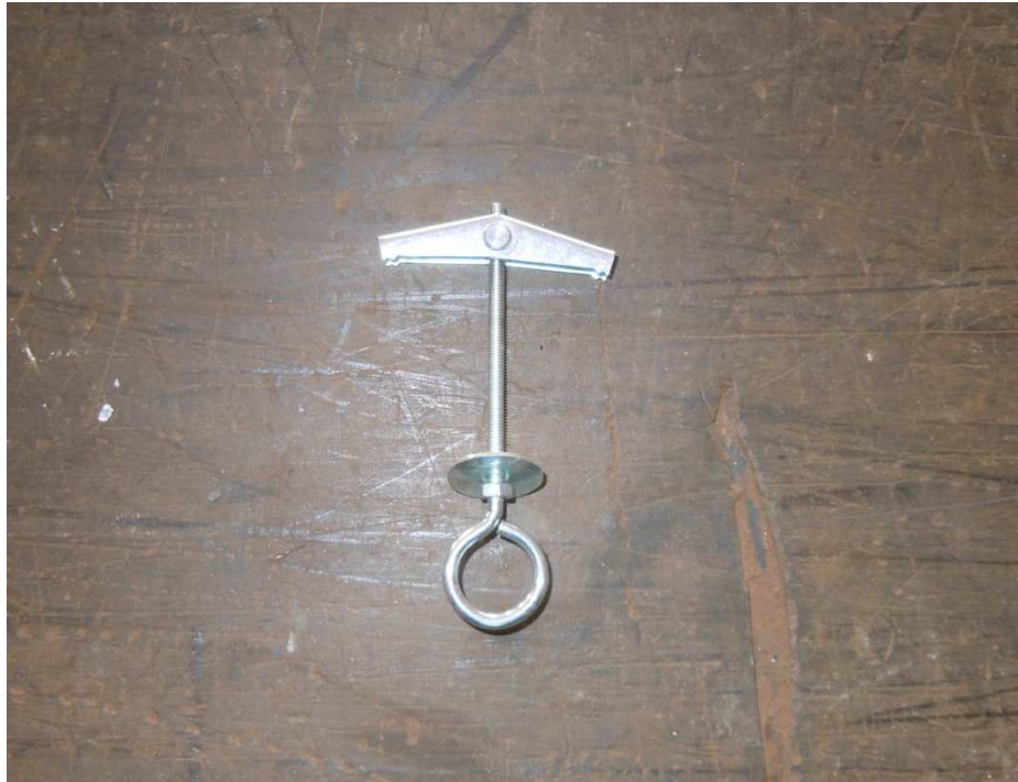
Foto n. 1 – Tassello ad “ancora” impiegato per l’applicazione della forza concentrata sul pannello
