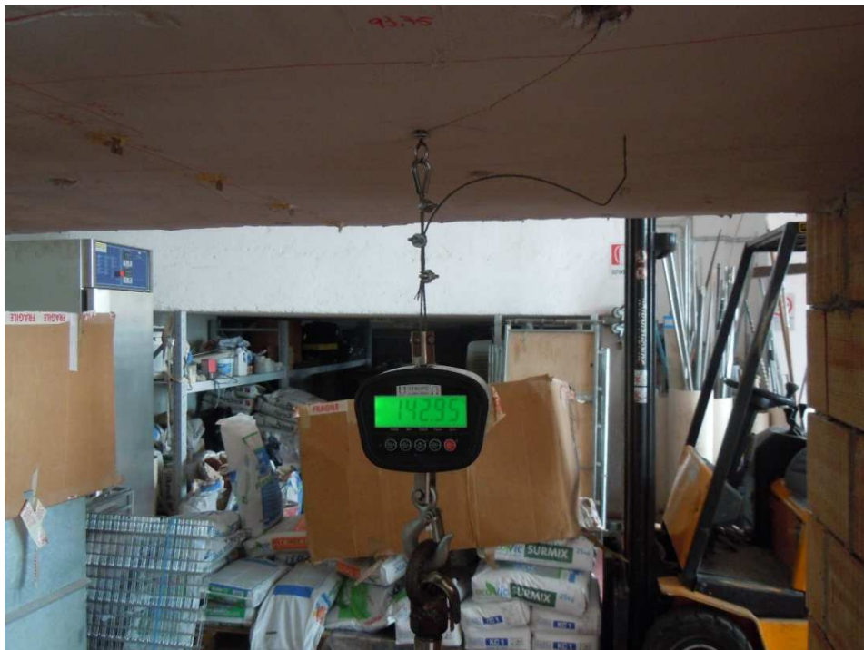
Foto n. 3.3 – Indicazione della forza massima, espressa in kgf, in fase di rottura (tassello 1)
