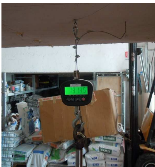
Foto n. 2.2 – Dinamometro elettronico per la misura della forza applicata
