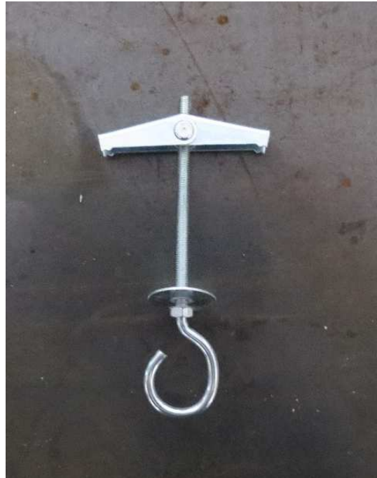
Foto n. 7 – Modalità di rottura del tassello nella prova “pilota”
