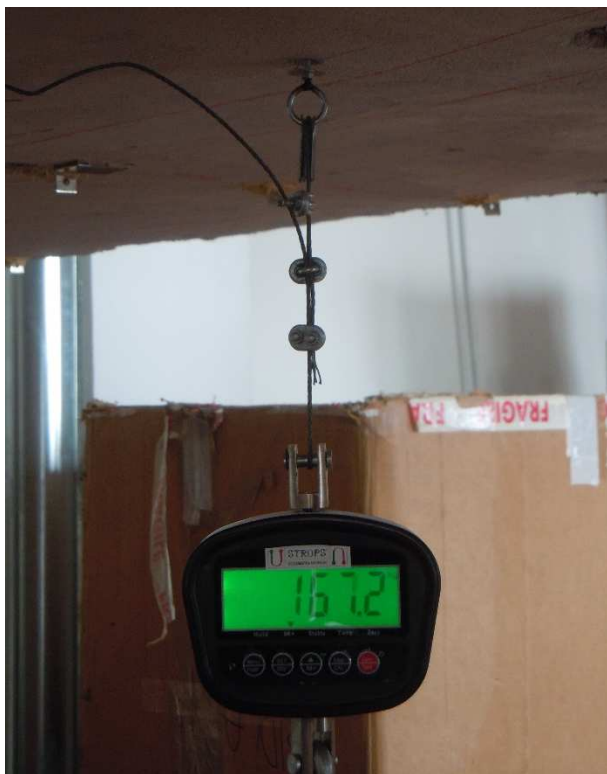
Foto n. 3.11 – Indicazione della forza massima, espressa in kgf, in fase di rottura (tassello 3)
