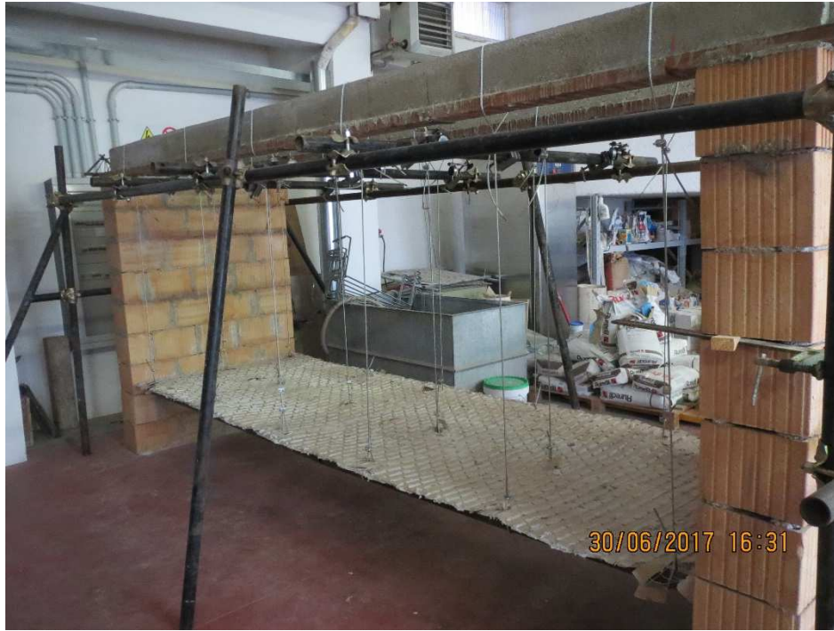
Foto n. 1 – Pannello Stucanet ® appeso ai travetti mediante tre file di pendini
