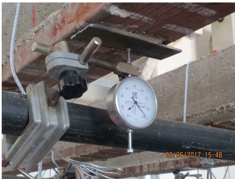
Foto n. 4 – Strumento di misura dell’abbassamento del punto centrale di un travetto
