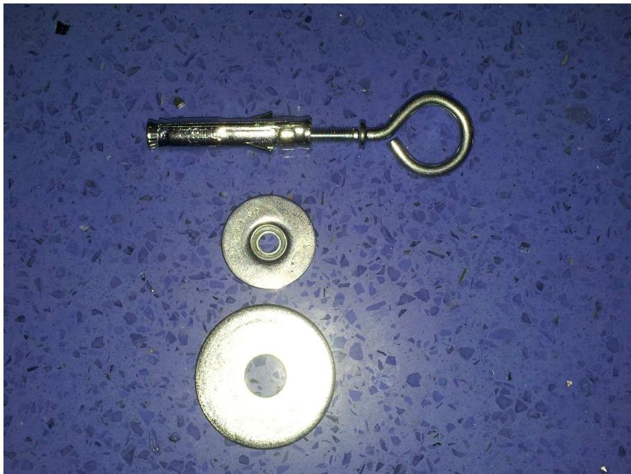
Foto n. 2.2.1.3 – Elementi base del fissaggio Fischer SBS 8/3 con occhiolo e rondella aggiuntiva
