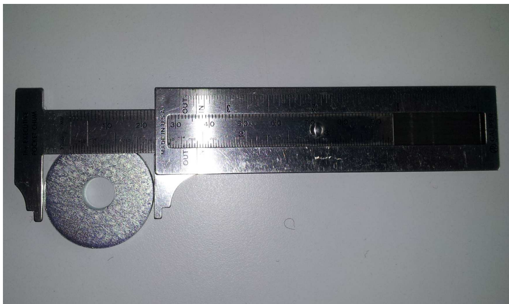
Foto n. 2.2.1.5 – Rondella aggiuntiva con diametro esterno di 32 mm, foro di 9,1 mm e spessore di 2,3 mm
