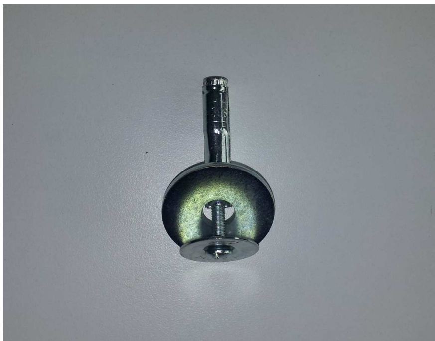
Foto n. 2.2.1.4 – Fissaggio Fischer SBS 8/4 con vite T.S.C. taglio combinato e rondella aggiuntiva
