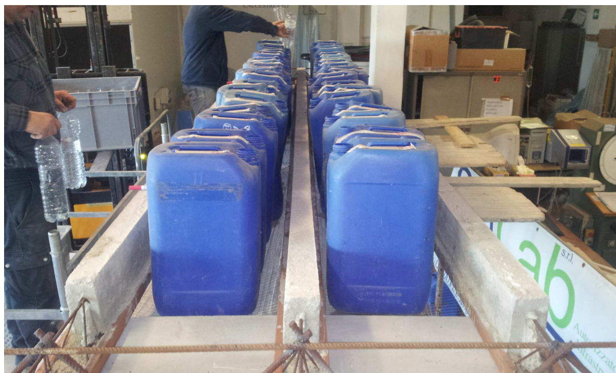
Foto n. 2.2.2.2 – Disposizione della zavorra
