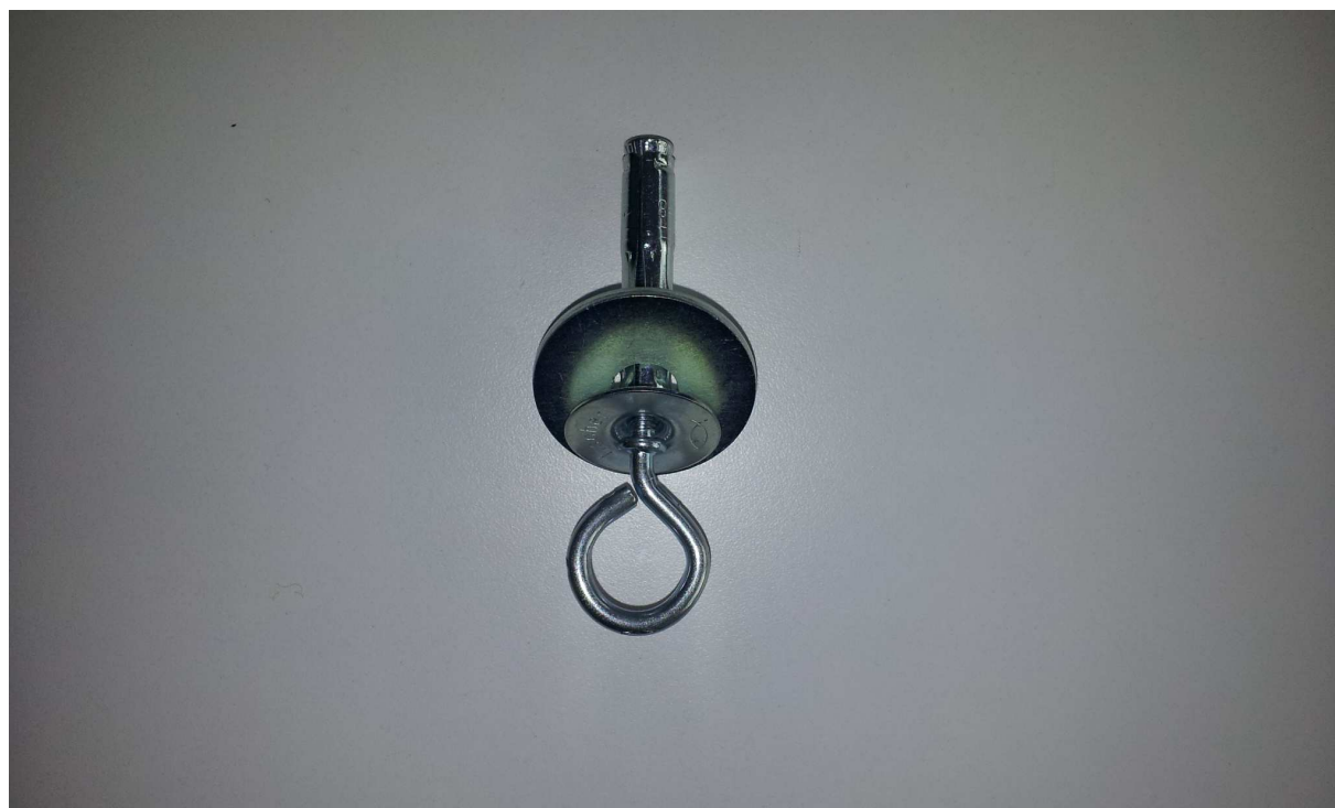
Foto n. 2.2.1.2 – Fischer SBS 8/3 con occhiolo chiuso per il fissaggio del rinvio al comparatore e rondella aggiuntiva
