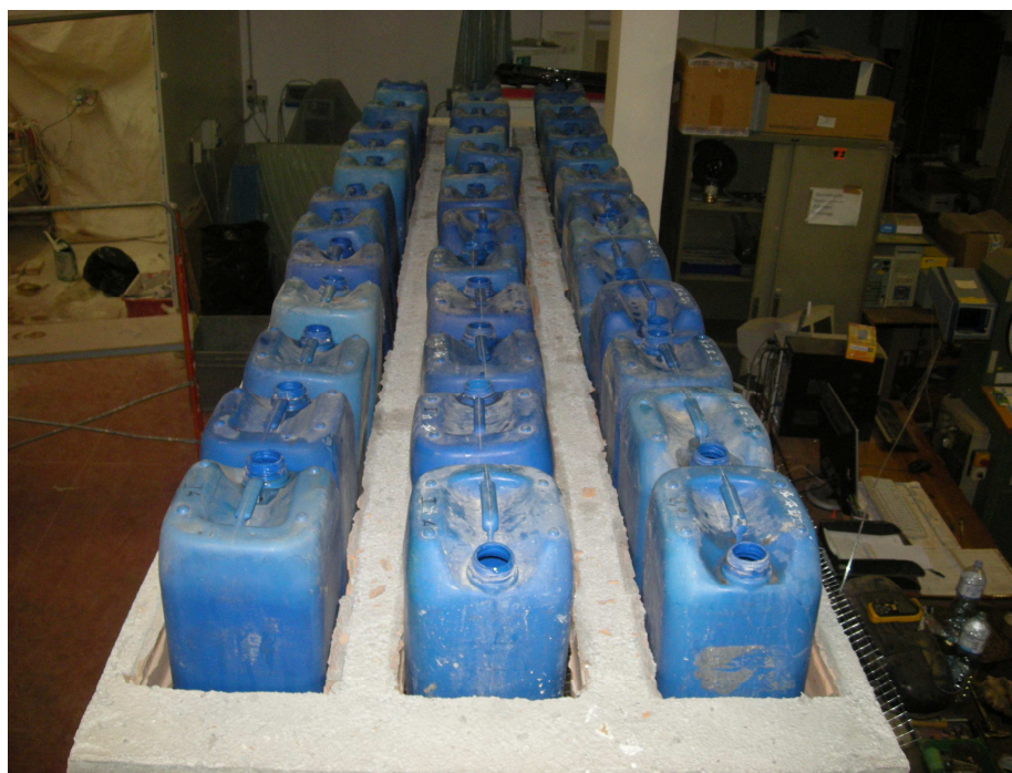
Foto n. 2.2.1.6 – Disposizione della zavorra di carico
