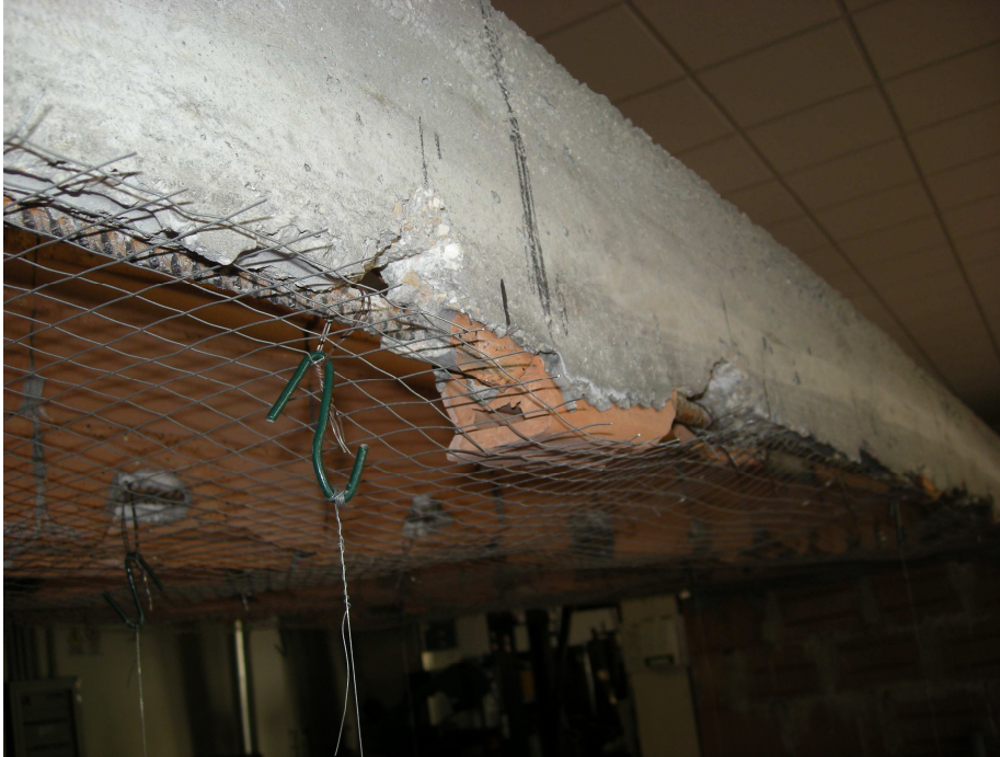
Foto n. 2.2.1.3 – Particolare del fissaggio della rete alla barra di armatura del travetto, e del gancio di rinvio al comparatore ancorato alla legatura con filo di ferro
