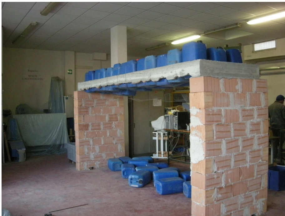
Foto n. 2.2.2.1 – Stato limite di collasso del “sistema”
