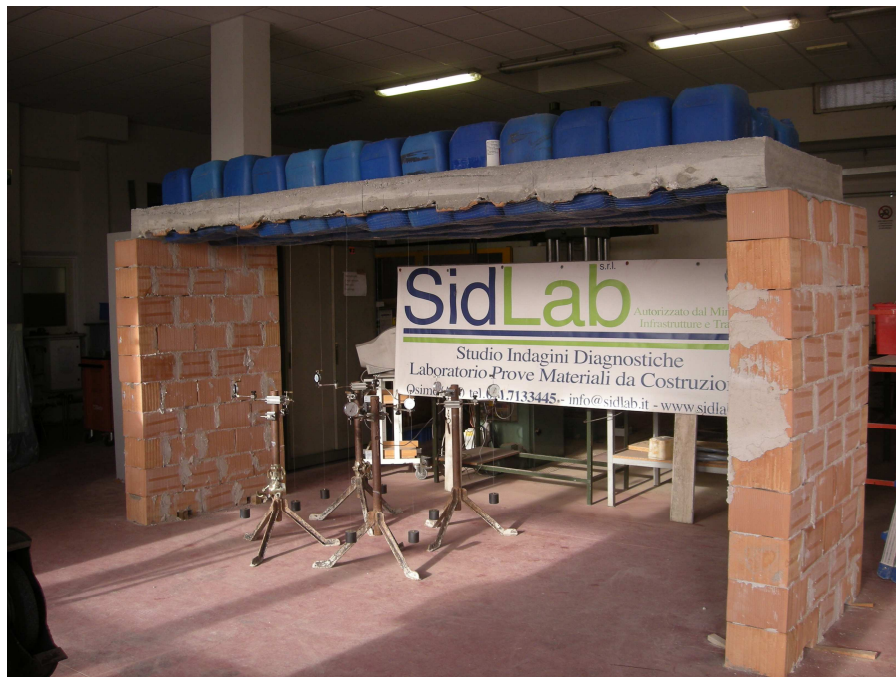
Foto n. 2.2.1.5 – Strumentazione di misura e zavorra di carico completa
